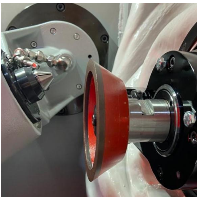
Fuso elétrico padrão com roda única
