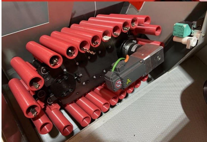
Bandeja numerada e carrossel de descarga
