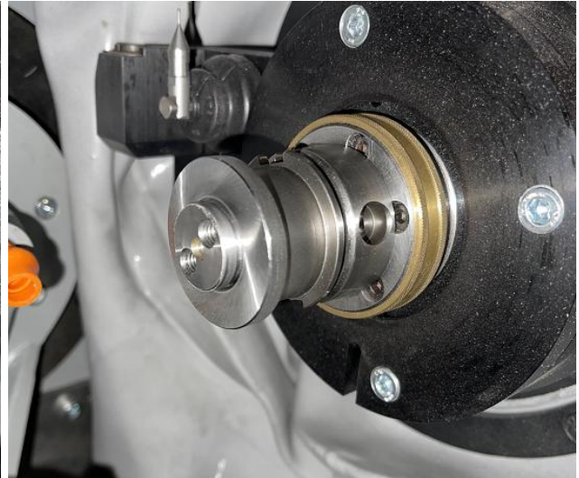
Elettromandrino opzionale con attacco HSK40
