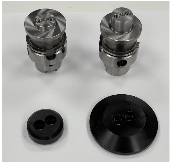
Attacco corto e lungo per HSK40
