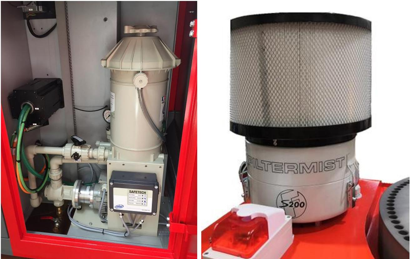
*Purificador de niebla Filtermist del sistema de filtración de cartucho Siebec*
