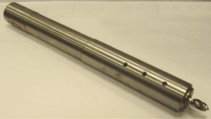
Set Spezialdorn für Spezialspannzangen Ø 40 mit 9 zylindrischen Spannzangen Ø 6, 8, 10, 12, 14, 16, 18, 20, 25 und 3 konischen Spannzangen MT1, MT2, MT3
