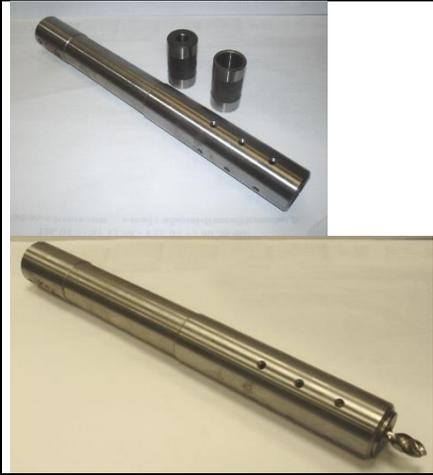
Ensemble mandrin à douille diamètre 40 livré avec 9 douilles cylindrique de diamètres 6, 8, 10, 12, 14, 16, 18, 20, 25 et 3 douilles coniques CM1, CM2, CM3
