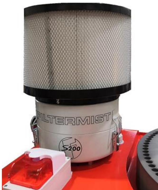
*Epurateur de brouillard Filtermist*
